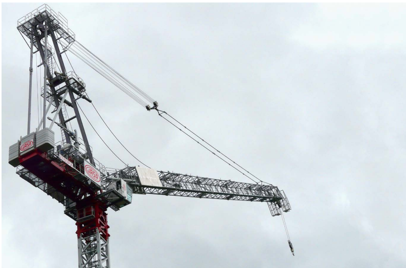
Der JASO J780PA. CASAR Doublefit wird als Hubseil eingesetzt, als Auslegerverstellseil kommt CASAR Parafit zum Einsatz.
